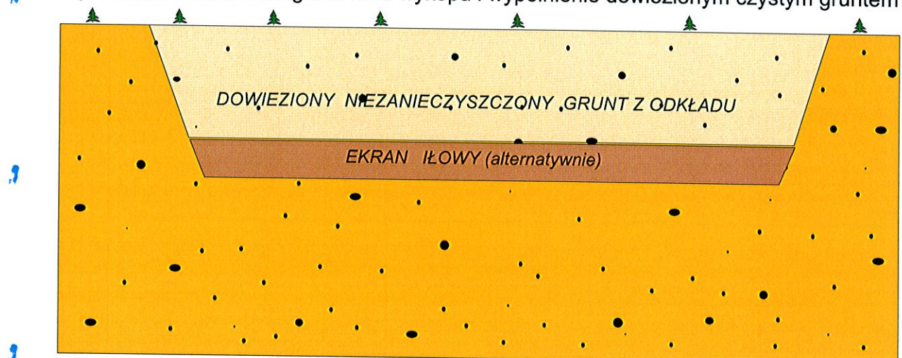
Wykonanie ekranu iłowego na dnie wykopu i wypełnienie dowiezionym czystym gruntem
