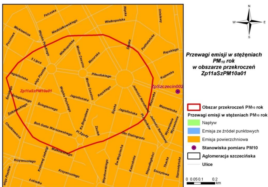
Rysunek 54 Przewagi typów emisji w stężeniach pyłu zawieszzonego PM 10 rok w obszarze przekroczeń Zp11aSzPM10a01 w strefie aglomeracja szczecińska w 2011 r.
