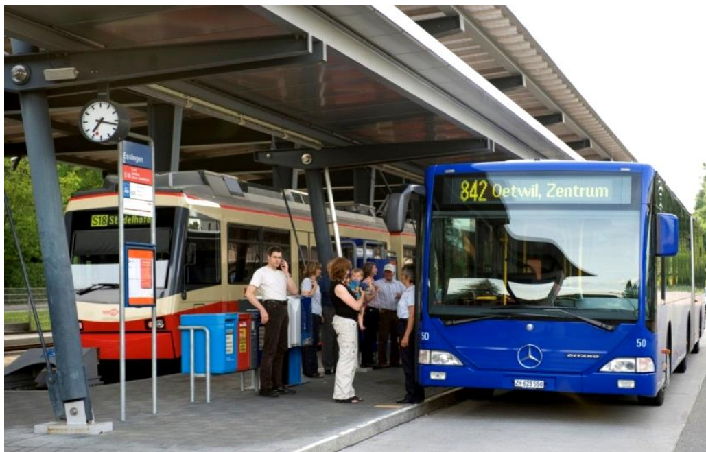
Rys. 13.5.2. Skoordynowana przestrzennie przesiadka pociąg-autobus typu „door-to-door” na stacji S-Bahn Esslingen koło Zurichu.
