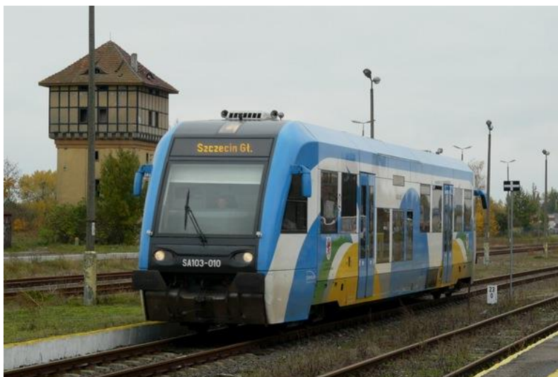
Rys. 4.1.1.3. Spalinowy wagon motorowy serii SA103 (producent PESA Bydgoszcz). 21
