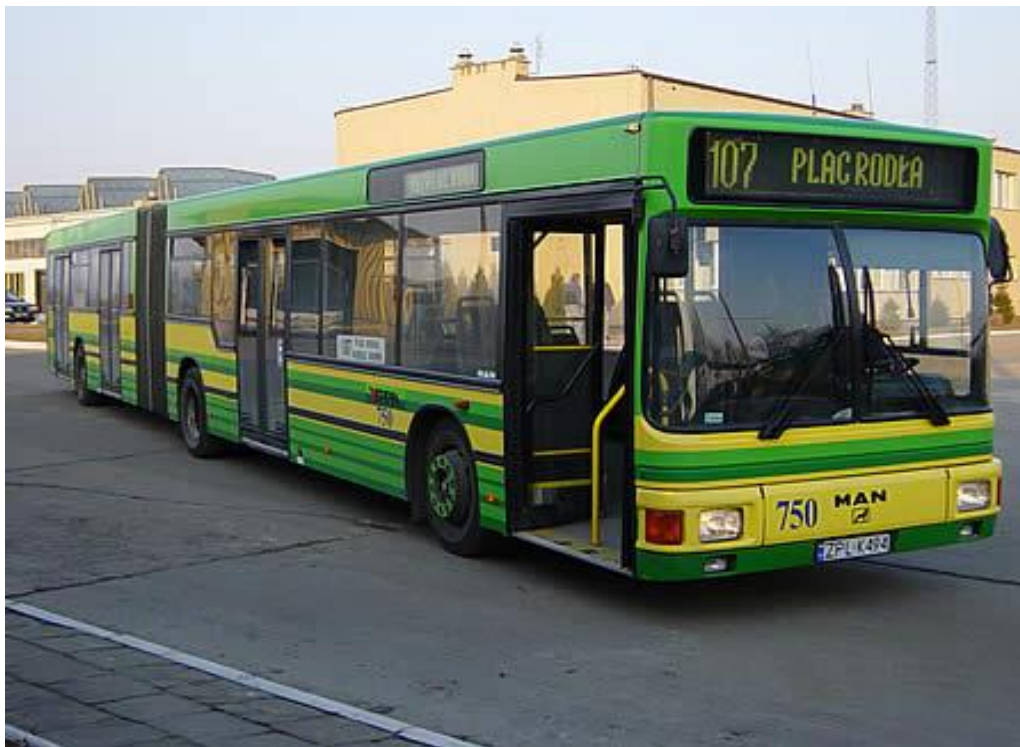
Rys. 9.5.1.1. Przykład autobusu z obniżoną podłogą przystosowanego do przewozu osób niepełnosprawnych w komunikacji zbiorowej.
