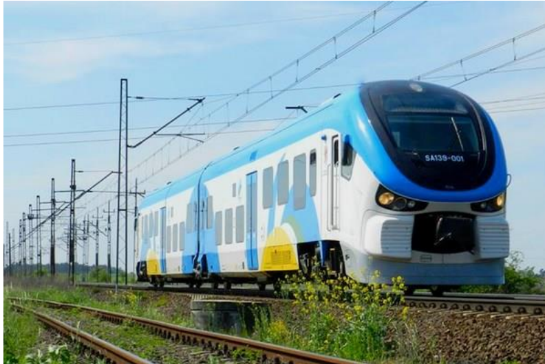
Rys. 4.1.1.6. Spalinowy zespół trakcyjny serii SA139. 24
