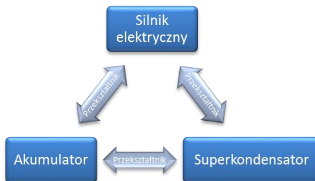
Rys. 20. Przepływ energii elektrycznej w urządzeniu z możliwością odzysku energii. źródło: opracowanie własne
